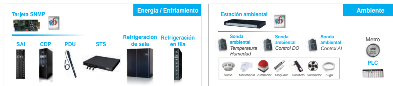
FIGURA 1. Aplicación de monitorización de InfraSuite Device Master de Delta
