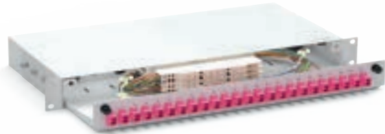
Bandeja de distribución 1U + Adaptadores + casetes + pigtails Capacidad máxima 24 adaptadores LC Dúplex
