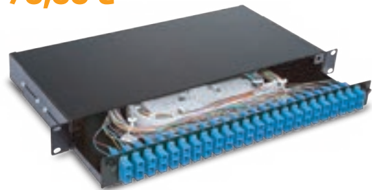
Bandeja de distribución 1U + Adaptadores + casetes + pigtails Capacidad máxima 24 adaptadores dúplex
